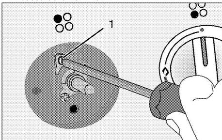
5. Impostare la lunghezza della fiamma da 2 a 3 mm con la vite 7 sul termostato del forno. Ruotando la vite in senso orario, si riduce la fiamma e ruotandola in senso antiorario, si accresce la fiamma.
